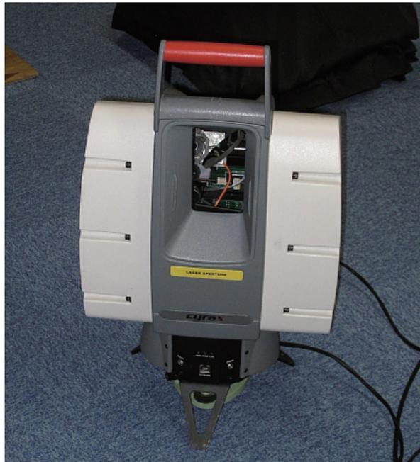
Fig.1 レーザレンジセンサ (Leica Geosystems 社製 HDS3000)
